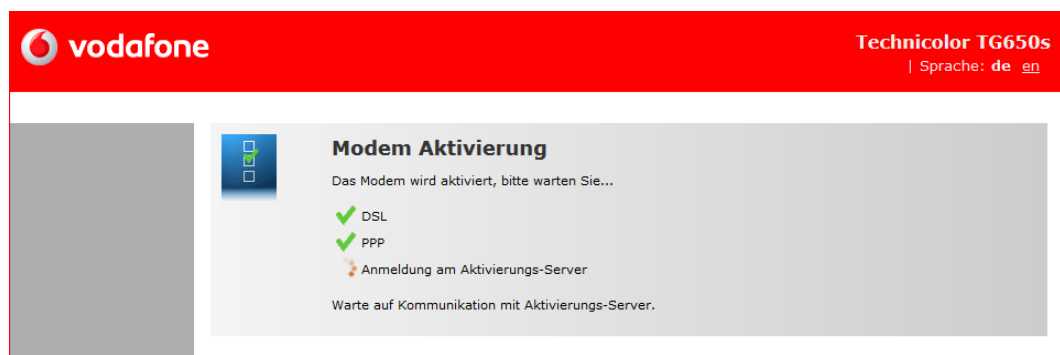
Abb. 10: Automatische Konfiguration SDSL-Router, Anmeldung am Aktivierungs-Server
