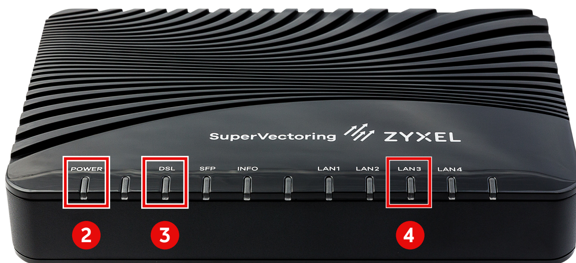
LED POWER , DSL und LAN3 am DSL-Modem ZyXEL VMG 3006
