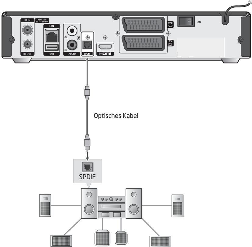
Verbinden Sie den Ausgang **[SPDIF]** auf der Rückseite des Receivers mit dem Eingang **Digital Audio In (SPDIF)** eines Audiogerätes mit Dolby-Digital-Unterstützung.
