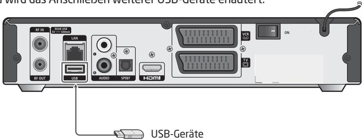
Verbinden Sie den Anschluss auf der Rückseite des Receivers über ein USB-Kabel mit den gewünschten USB-Geräten. Der USB-Anschluss ist zu Beginn ohne Funktion.
