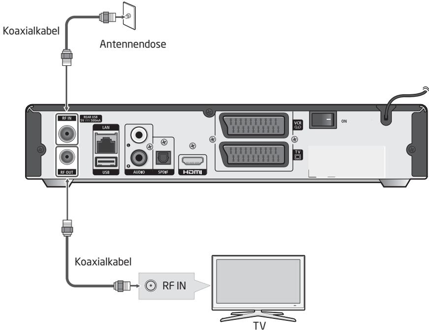
Verbinden Sie den Eingang **[RF IN]** auf der Rückseite des Receivers über das Kabel mit der Kabelbuchse Ihres Haushalts.
