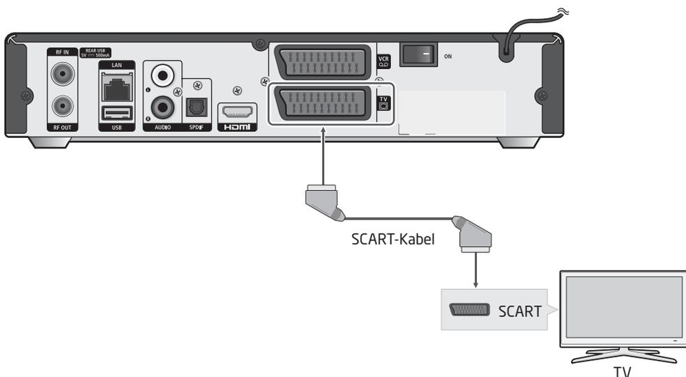
Verbinden Sie den Ausgang **[TV SCART]** auf der Rückseite des Receivers mit einem SCART-Kabel mit dem **[SCART]**-Eingang des Fernsehgerätes.
