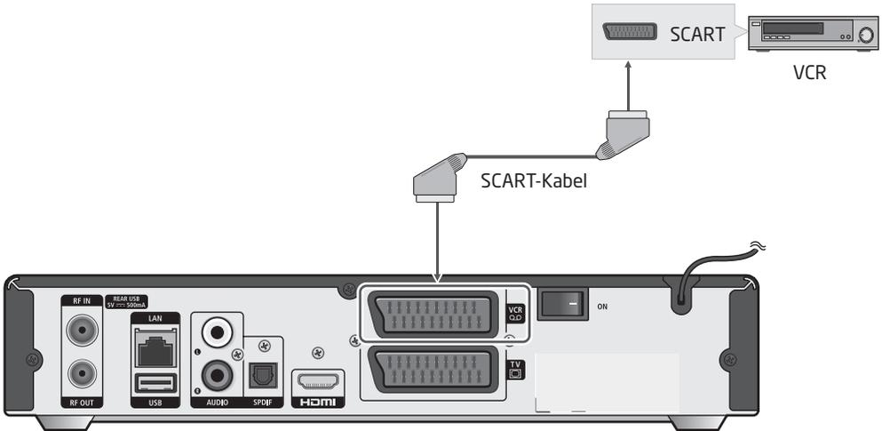
Verbinden Sie den Ausgang **[VCR SCART]** der Set-top-Box über ein SCART-Kabel mit dem SCART-Eingang des Videorekorders.
